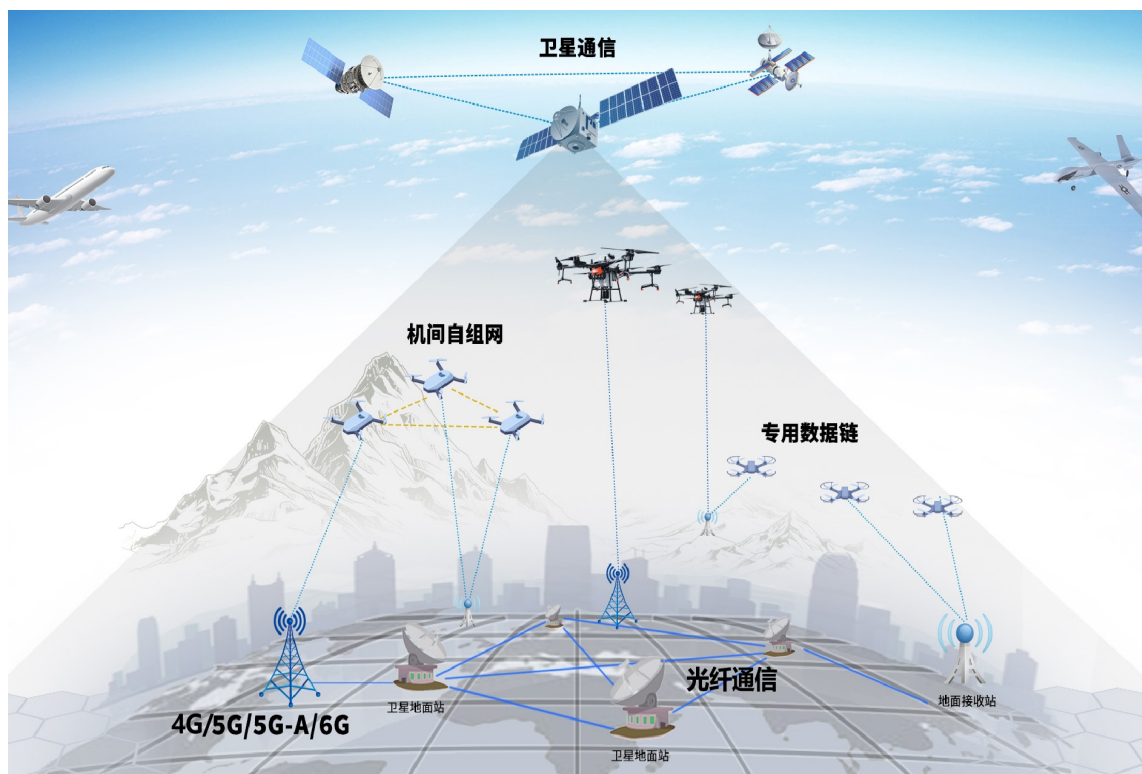
图 8 低空通信概念示意图
